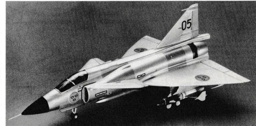
サーブAJ-37ビゲンは、スウェーデン空軍の多目的戦闘機です。独自の武装中立政策から装備も極力国産開発しているため、攻撃型AJ-37、要撃戦闘型JA-37、偵察型SF-37、哨戒型SH-37と広い範囲の任務に合わせた型があります。このため低空進攻から中・高々度での空戦性能の調和を図るためコ・デルタ（複三角翼）を採用しています。
