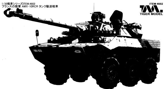
パナールEBR重型装甲機動車を置き換える要望を満たすため、GIATグループによって研 究開発、生産されました。20世紀80年代から、フランス陸軍は引き続き、AMX-10RCを284 台を購入しました。モロッコ、カタールもこの戦車を購入し、整備しました。AMX-10RCは、フランス陸軍のチャド、湾岸戦争、ボスニア、アフガニスタン紛争などで姿を現れたことがあります。また、AMX-10RCR新型戦車は、フランスが旧型のAMX-10RCを改善したもので 車載設備及び鋼製間隔装甲が強化され、後ろの噴水器と全部の防波板を取り、水陸両 用機能を取消しました。2010年に戦車の改造が全部完成され、新型AMX-10RCRは、引き 続きフランス部隊で現役戦車として活躍すると思われます。
