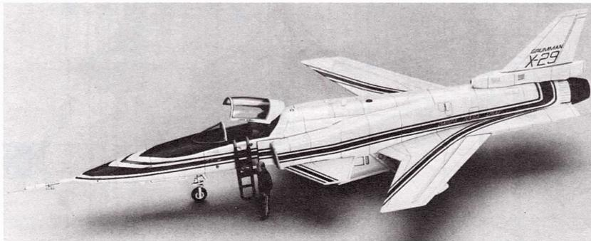
グラマンX-29A ATD (Advanced Technology Demonstrator)は、前進翼戦闘機の实用性を試す実験機として開発されました。前進翼機の大きな特長は、前に向かって角度がついている主翼で、最新の複合材料技術によって作られています。又、格闘戦闘時、あらゆる速度域において優れた機動性を持っています。この為、操縦装置は、スペースシャトルと同じデジタル・フライ・バイ・ワイヤー方式を使い、1秒間に40回もの計算をして機体の安定性と機動性を保っています。
