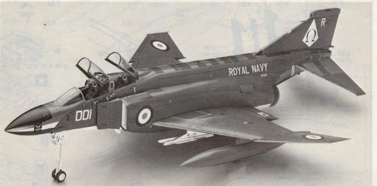
マクドネルダグラス・ファントムFG.1は、イギリス海軍の全天候艦上要撃戦闘機とし て開発されました。FG.1は、アメリカ海軍のF-4Jと基本的に同じですが、エンジンを GE製J-79から大出力のRR.スペイに換装したのが最大の特徴です。これにより、空気 取入口は20%程増積され、エンジン過熱防止のために補助空気取入口が新設されました。 また、発進時の迎え角を大きくするため、前脚柱が2段式に延長できるようになりまし た。さらに、フラップと連動して下がるドループエルロンや固定スラット付水平尾翼を 採用して、離着艦性能を高めています。海軍では空母アークロイヤルに配備された第892 飛行隊が唯一の実戦部隊でしたが、1979年までに全機が空軍へ移管されました。その際、 ILS(計器着陸装置)アンテナが垂直尾翼に設置され、ガンボッドの運用能力が付加され ました。イギリス空軍でFG.1を運用するのは、第43飛行隊と第111飛行隊です。両部隊 ともにイギリス北部の要撃任務に就いています。
