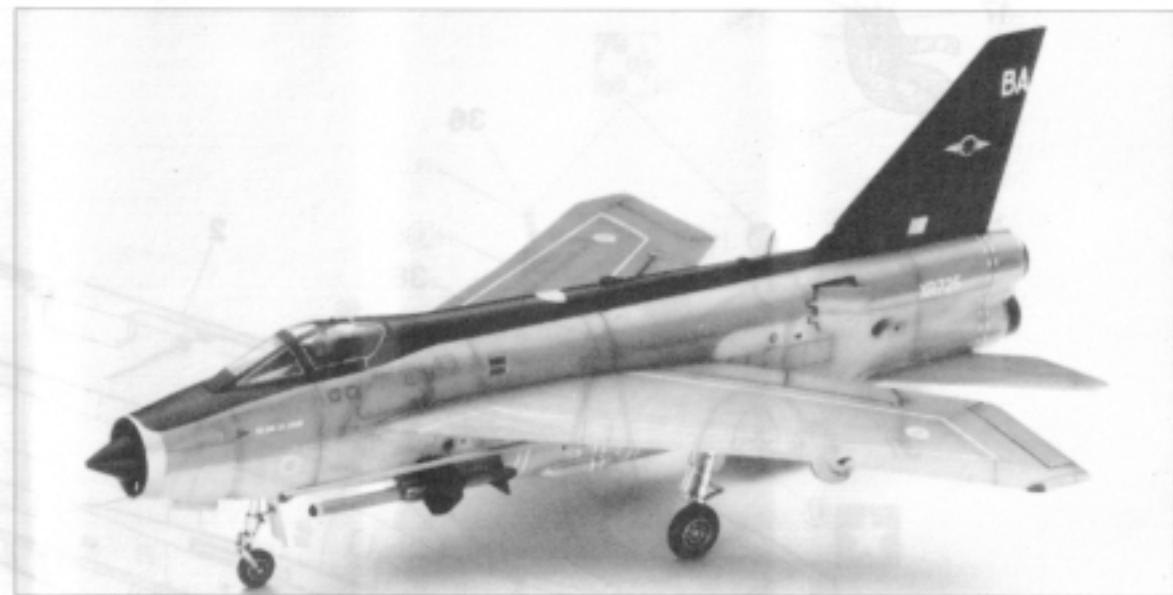
BAC ライトニングは、イギリスで開発、生産された超音速戦闘機です。F Mk.6は新主翼の採用、胴体下部張出しタンクの大型化、主翼上面増槽タンクの装備などにより航続性能が向上しました。のちに胴体下部張出しタンク前部に30mmアデン砲2門と胴体後部下面にアレスター・フックを装備しました。F Mk.1が実戦配備さ
