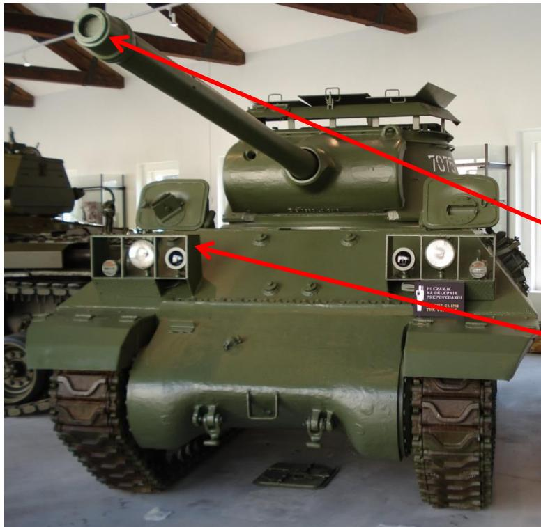
NO GAS BRAKE ON THE BARREL
